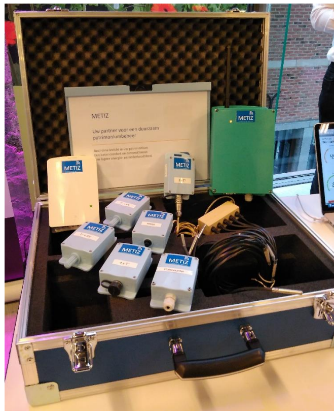
Een set van draadloze sensoren voor het meten van luchtkwaliteit in kantoren, temperaturen van leidingen, pulsen van energiemeters en prestaties van een luchtgroep.
